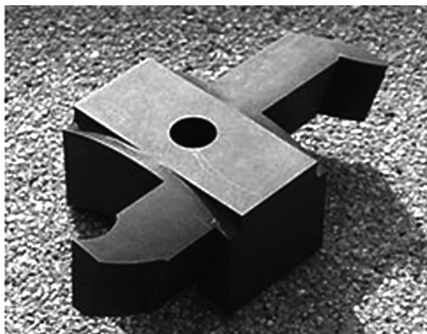
图9 闭式整体涡轮盘电火花加工成形电极
