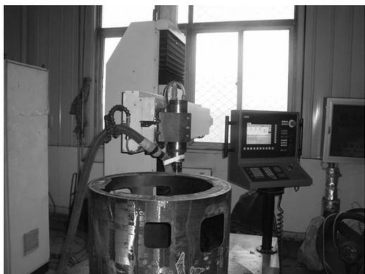
图 1 碳纤维复合材料数控高速钻磨机床
