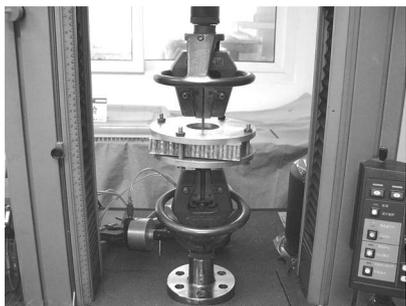
图 1 埋件拉脱力测试图
