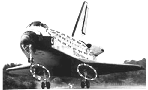
图 1 航天飞机基线密封(baseline seal)位置
