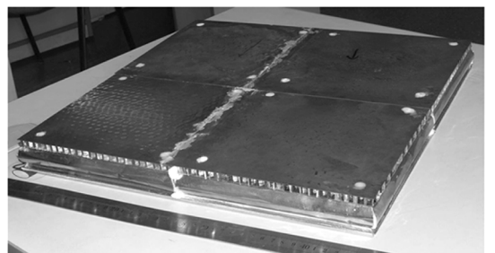
图3 “冷连接”的2×2的Inconel 617合金金属TPS阵列(类似美国新一代ARMOR TPS结构)
