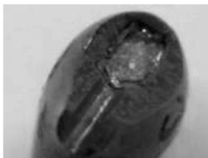
图5 电容引线彻底脱落照片
