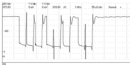
图5 侧向喷雾的放电波形
