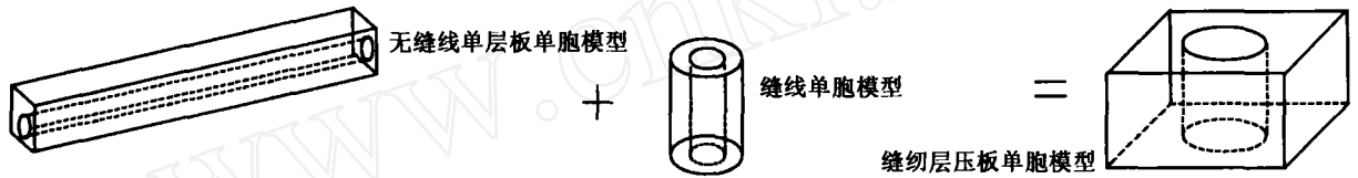
图2 缝纫层压板二级单胞模型
