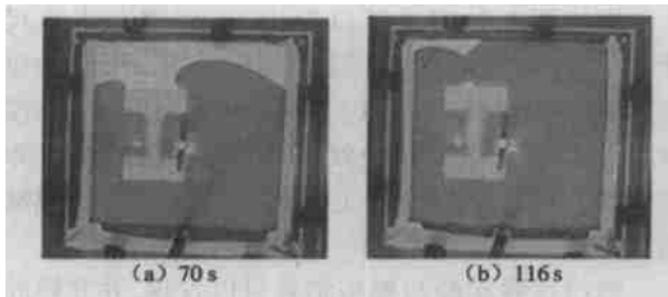
图6 号工字型孔二维平板不同时刻的 实验结果流动前锋位置
