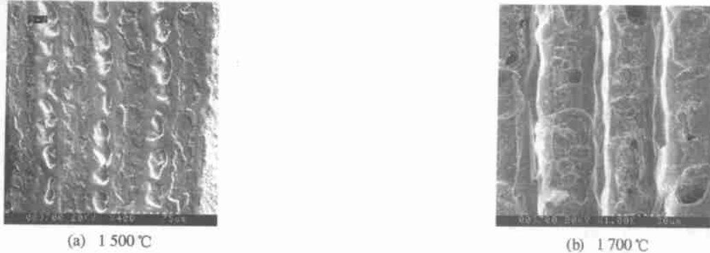
图6 经 15 h 热暴露后 Nb/Mo 复合材料(带涂层)的显微结构(SEM)
