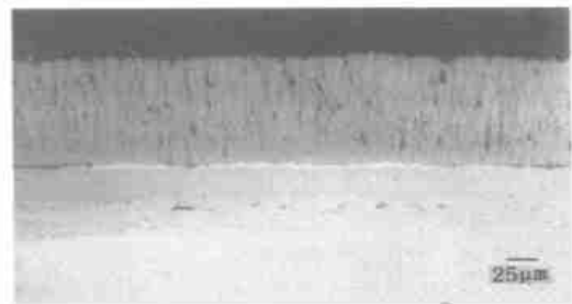
图 6 用 EB-PVD 制备 TBCs 的显微结构
