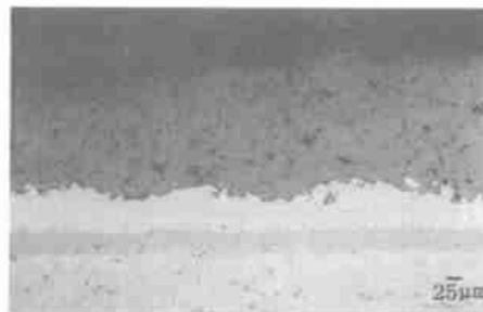
图 4 用 APS 制备 TBCs 的显微结构
