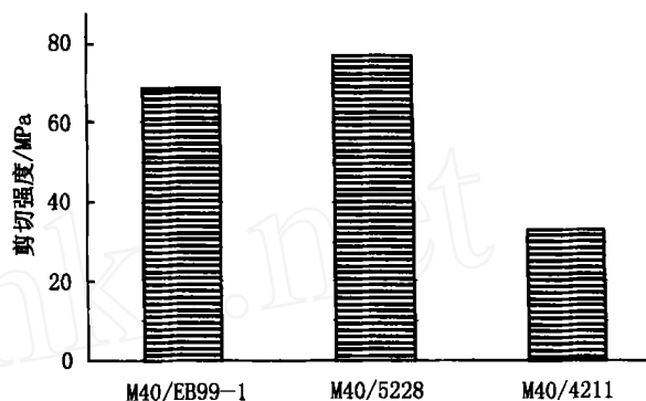
图3 三种不同基体复合材料剪切强度比较
