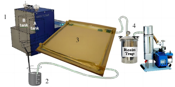
注:(1)自制混料单元;(2)树脂缓冲装置;(3)模具和加热系统;(4)压力控制系统。
