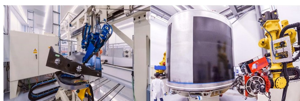
图18 罗罗公司复合材料风扇叶片及机匣自动铺放设备
