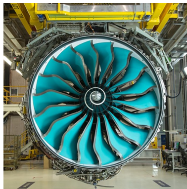
图10 罗罗公司开发的C/Ti复合材料风扇 Fig. 10 C/Ti composite fan developed by RR
