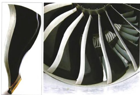
图3 GE90-115B发动机及其复合材料风扇叶片 Fig. 3 GE90-115B engine and its composite fan blade
