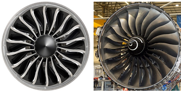
图1 GENx复合材料风扇叶片(左18片)与Trent 1000钛合金风扇叶片(右20片)对比
