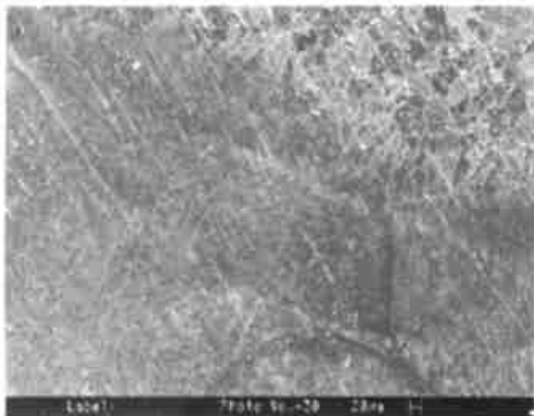
图8 焊缝区内部裂纹 60 ×
