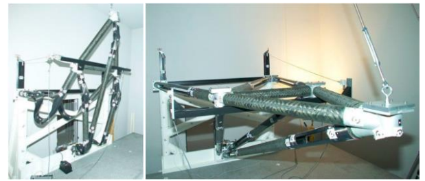
图3 收拢和展开状态的整体铰链光学支撑结构
