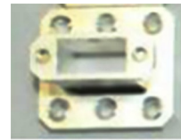
图11 波导负载试验件1功率耐受试验开盖检测结果
