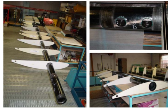
图2 Heliplat无人机机翼结构
