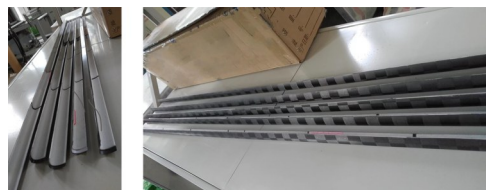
图11 碳纤维复合材料前缘
