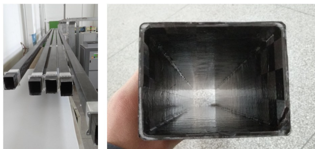
图5 碳纤维复合材料泡沫夹芯结构中梁及截面
