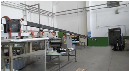
(b) 外梁抗弯试验
