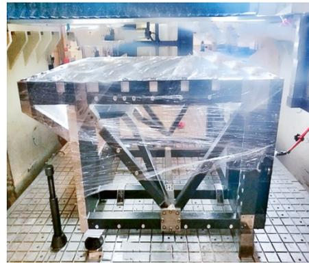
图13 桁架结构机加工过程
