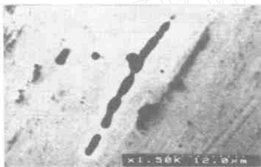
(b) 裂纹分节,裂尖锐化 920 / 1 h
