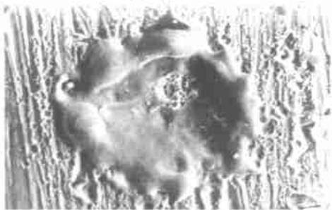
图 1 钢针电极—钢(-)放电凹坑的电镜扫描照片 370  $\times$
