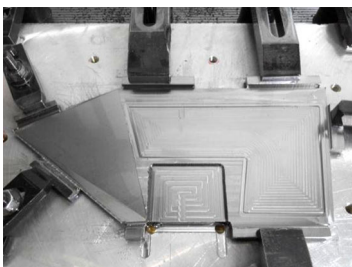
(b) 骨架零件装夹状态下现场图
