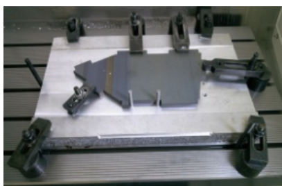
(b) 零件装夹及基准设置实物图
