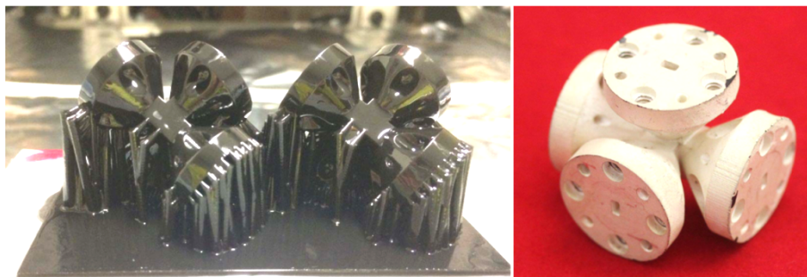
图7 数字光处理打印制备的四通道混合波导组件
