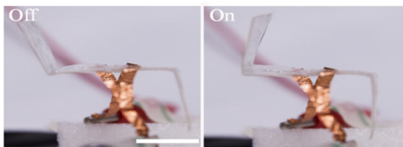
(c) 介电弹性体折纸结构
