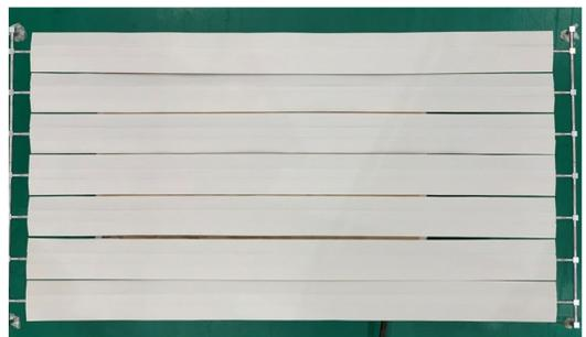
图5 辐射器(2 m×1.5 m)表面喷涂热控涂层
