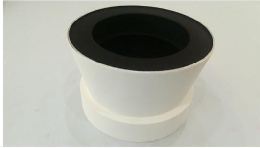
图3 遮光罩外表面喷涂热控涂层
