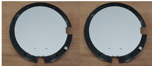
图4 CFRP天线表面喷涂热控涂层
