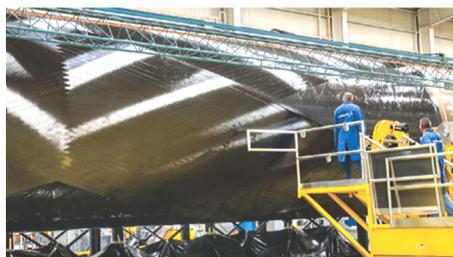
图4 低温复合材料贮箱缠绕成型过程
