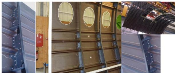
图8 复合材料蒙皮桁条结构
