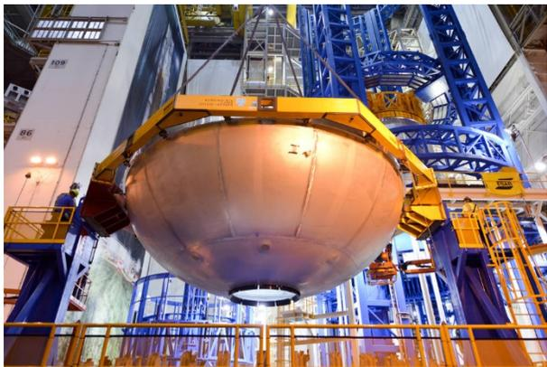
图6 SLS火箭箱底搅拌摩擦焊接
