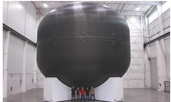
图2 12m直径复合材料贮箱
