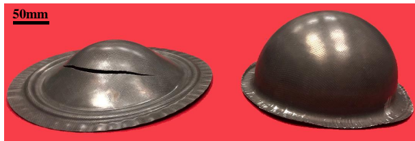
(a) 常温成形 (b) 超低温成形 图6 不同温度条件下成形半球试件
