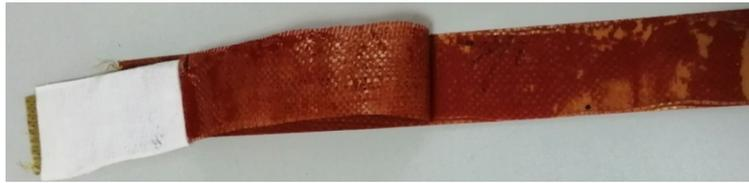
图5 PI膜及PI编织布均未经表面处理试样剥离面形貌状态图
