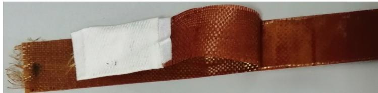
图7 PI膜及PI编织布均经表面处理试样剥离面形貌状态图
