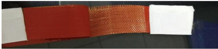
图6 PI膜经表面处理PI编织布未经处理试样剥离面形貌状态图
