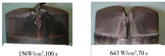
图5 PICA与缝隙填充材料烧蚀不匹配
