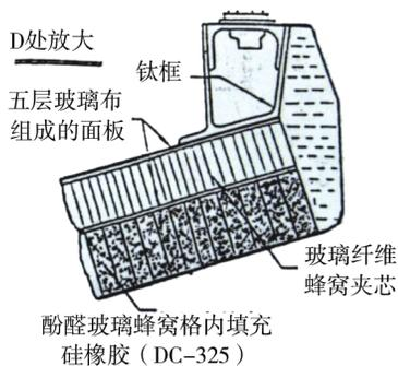
图2 双子座飞船隔热结构
