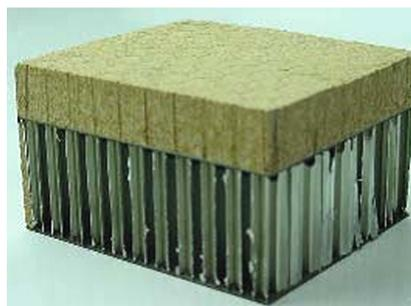
图8 SLA-561 V耐热材料
