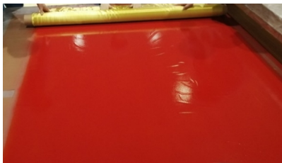
图8 大面积聚酰亚胺薄膜丝网涂胶实物照片
