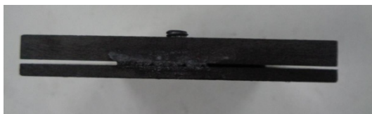
图 16 间隙为 1 mm 平板试验后状态
