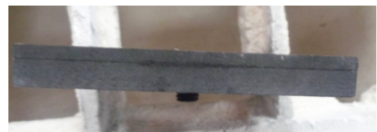
图14 间隙为0.2 mm平板试验后状态
