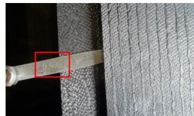
图3 蒙皮与骨架间隙实测值
