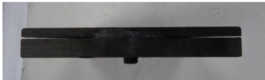
图 15 间隙为 0.6 mm 平板试验后状态
