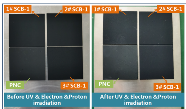
图6 真空-紫外、电子及质子辐照前后 SCB-1 与 PNC 涂层外观状态
