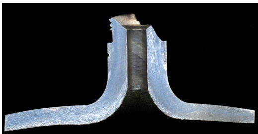
图 15 改进后气瓶瓶嘴根部处的金相组织
