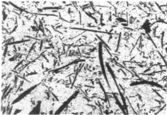
图 2 B 层复合材料纤维分布方向的金相照片 100 ×
