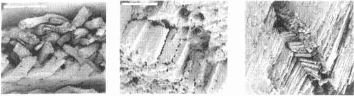
(a) 断口纤维束界面严重脱落 (b) 纤维和树脂界面 (c) 纤维束被冲击剪断
