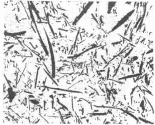
图 1 20%Al 2 O 3f /ZL109 复合材料金相照片 100 ×
