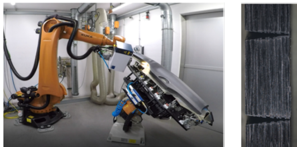
图 4 三维激光切割系统及切割的 5 mm 厚 CFRP 复材板 Fig. 4 3D laser cutting system and 5 mm thick CFRP composite plate
