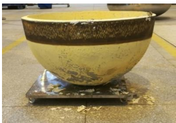
图9 等温冲压试验得到的半球壳体毛坯件
