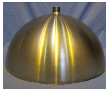
图14 完成加工的TA7ELI钛合金半球
