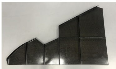
图4 成型后的隔框实物图
