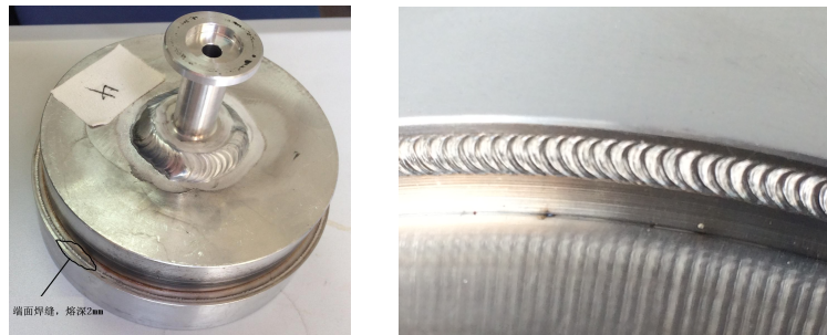
图5 铝合金腔体结构模拟件
