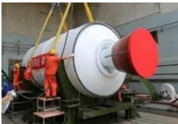
图10 \Phi 3 m两分段固体发动机 Fig. 10 \Phi 3 m two segments SRM
