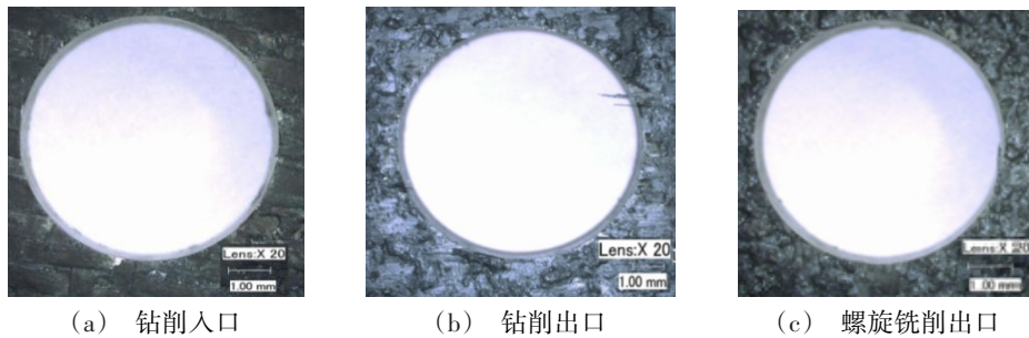
图3 PCD钻孔和PCD螺旋铣孔的进出口质量
