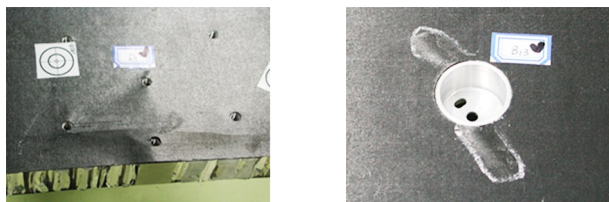
图3 在热真空试验下的失效的含埋件蜂窝板
