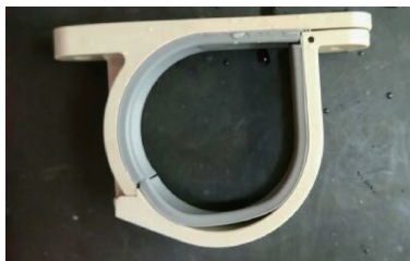
图 5 湿热试验后箍带与胶垫剥离样件照片
