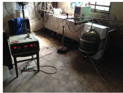
图8 气瓶疲劳寿命试验照片
