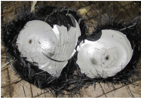
图6 气瓶爆破照片
