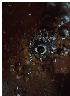
图7 25°(螺旋角 p )/15°(后角 \alpha ) 钻头加工切屑形式
