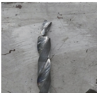
图6 35°(螺旋角 p )/15°(后角 \alpha ) 钻头加工后情况
