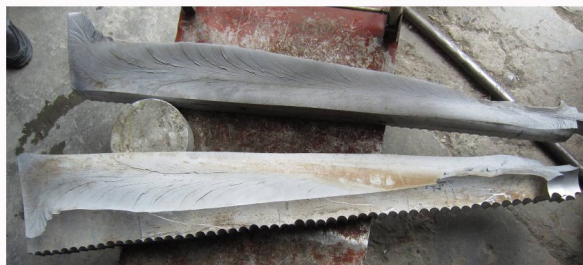
图 6 裂纹打开后宏观形貌
