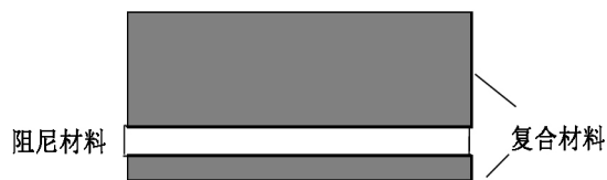
图 1 结构/阻尼一体化复合材料结构示意图
