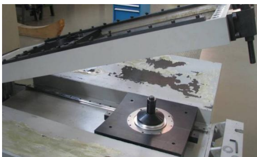
(a) 法兰焊接垫板
