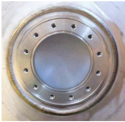
(a) 法兰焊漏
